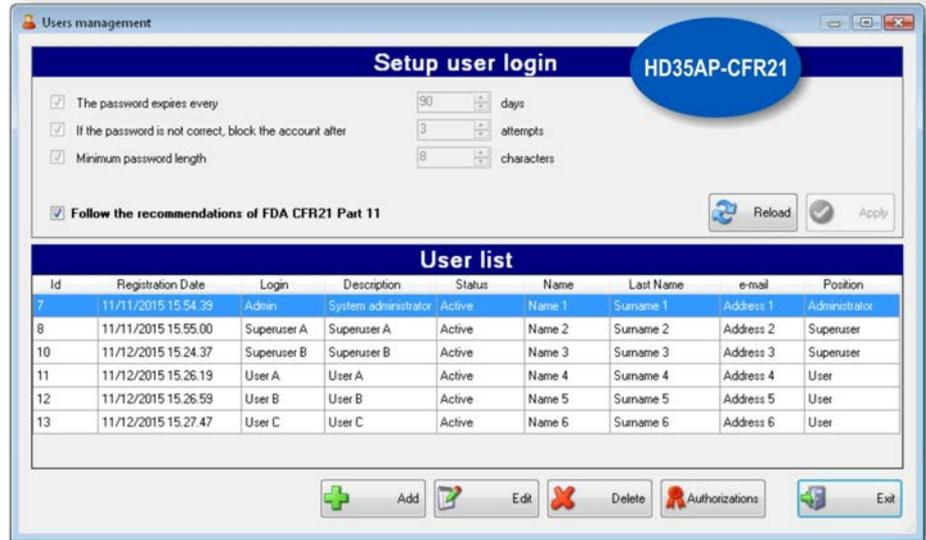
L'option HD35AP-CFR21 fonctionne avec une clé matérielle USB pour être connectée à un PC connecté au même réseau local que le PC sur lequel le logiciel HD35AP-S est installé.
