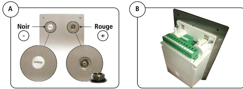
**Étalonnage en face avant :** Ce système permet d'isoler les arrivées de pression arrière et d'avoir accès par la face avant directement à l'élément sensible de l'appareil. Au moment de l'étalonnage, ce système permet, sans rien démonter, de raccorder le capteur-transmetteur encastré à un générateur de pression et à un banc d'étalonnage. Il est désormais possible d'effectuer un étalonnage directement par la face avant des capteur-transmetteurs encastrables, sans avoir à les démonter.
