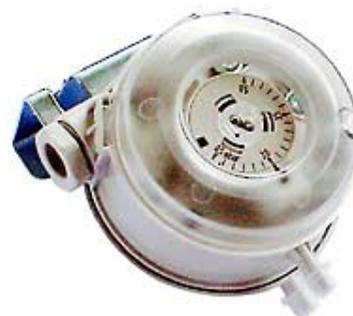
Les pressostats d'air différentiel à membrane sont utilisés pour la surveillance des installations de traitement d'air. Ils permettent, sans alimentation, d'établir un contact tout ou rien lors du dépassement d'une pression de consigne. Ils peuvent être montés en parallèle avec un manomètre à colonne de liquide ou à aiguille en surveillance de débit. Ils peuvent être couplés à un tube de pitot ou à une aile de mesure débimé.
